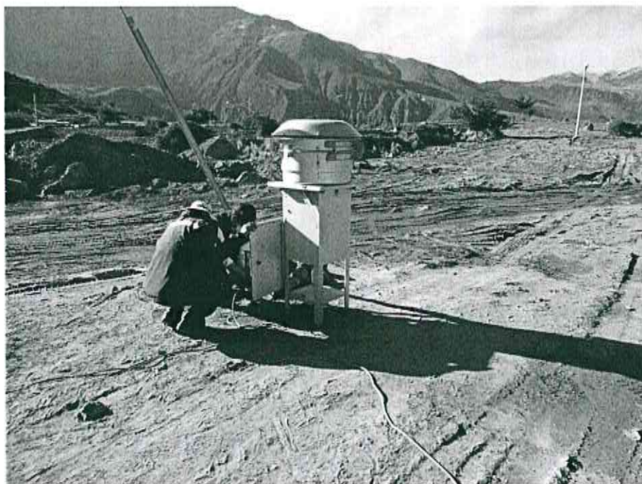
Foto 11: Instalación del muestreador de alto volumen para PM10 (DIGESA) en las cercanías del albergue de Querapi ubicado en el centro poblado de Sacohaya, vista tomada el 25 de Abril del 2014.
