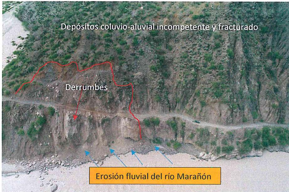
**Figura 34.** Zona propensa a derrumbes y Erosión fluvial de terrazas mixtas por actividad del río Marañón que clasifica a esta zona como potencialmente peligrosa a ser transitada, Tramo Chagual-Víjus. Fuente: Elaboración propia 2019.
