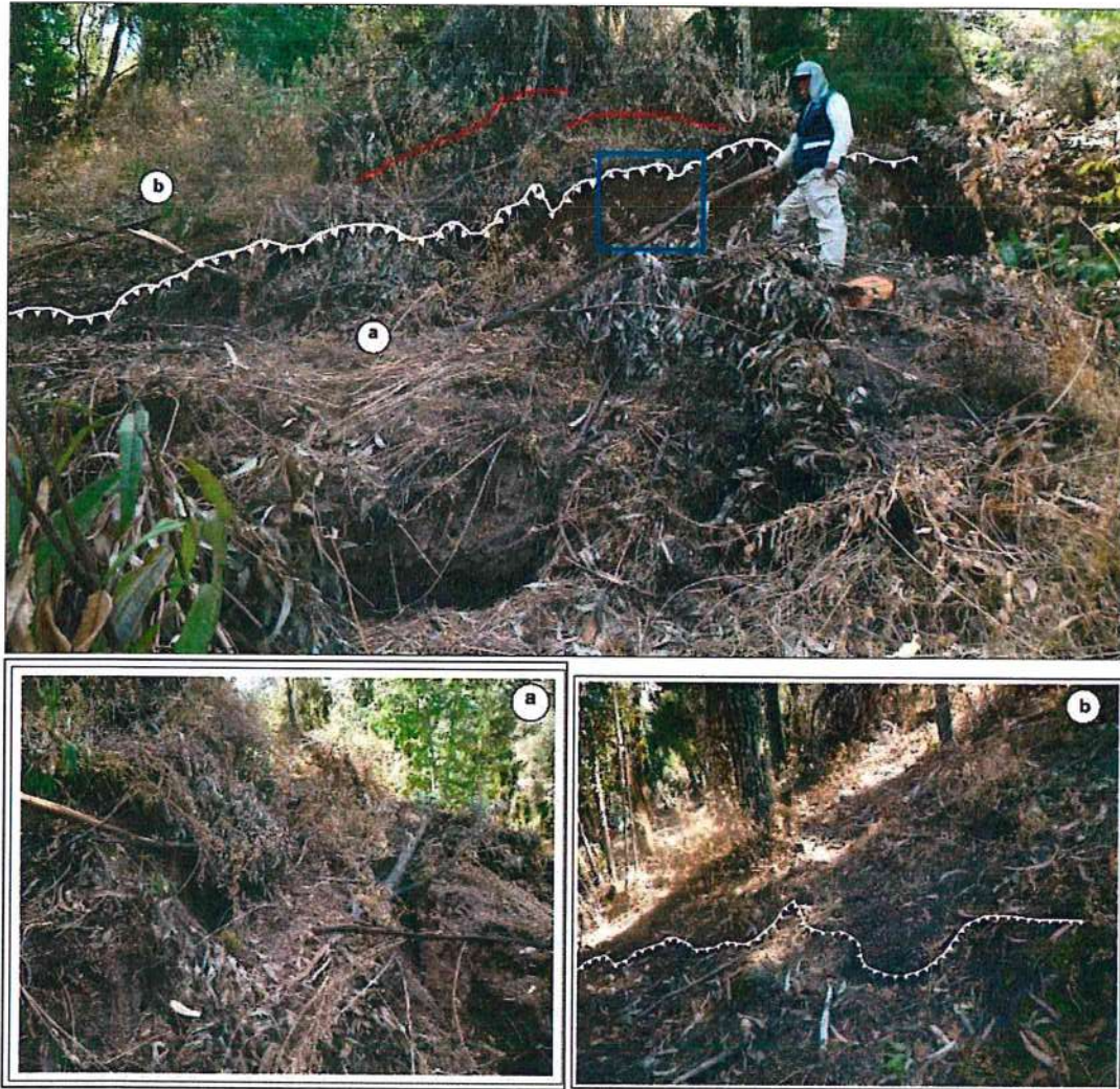
Figura 10. Escarpe del flanco derecho (deslizamiento rotacional reactivado), muestra un salto de 1.5 m. a) Zona de agrietamientos en el cuerpo del deslizamiento b) Desplazamientos en la parte superior del escarpe
