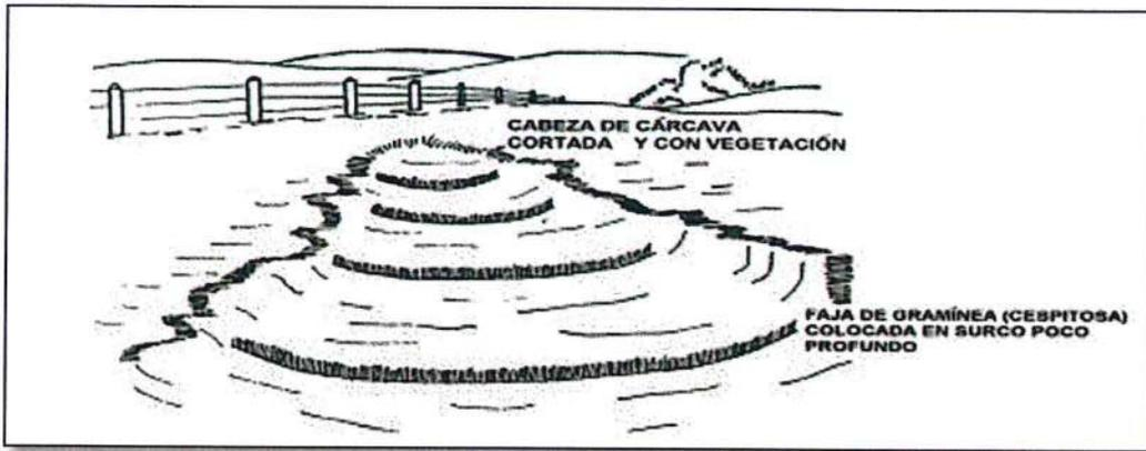
**Figura 23.** Control de pequeña cárcava mediante bandas de cubiertas vegetales (Hull, 1959).
