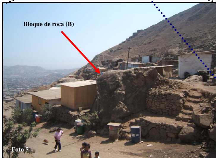
Fotos 3.- Vista de la margen derecha de la quebrada Progreso. Foto 4.- Tamaño de los bloques sueltos que pueden ceder (A) Foto 5.- Tamaño de los bloques que han caído (B). Foto 6.- Muestra los bloques esparcidos en la ladera.
