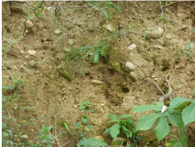
Fotografía 5. Se muestra los depósitos, conformados por arena-limosa, con algunos clastos de formas redondeadas, dispuesto en forma caótica.
