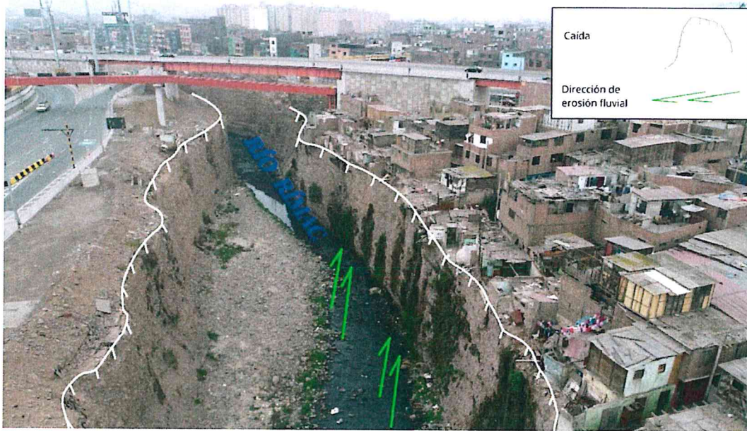
Figura 11 Interpretación de fotografías aéreas mostrando la erosión fluvial en la margen derecha del río Rímac
