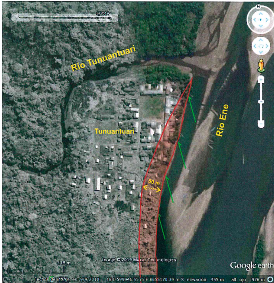
Figura 8. Imagen satelital del año 2014, se zona afectada por la erosión fluvial.
