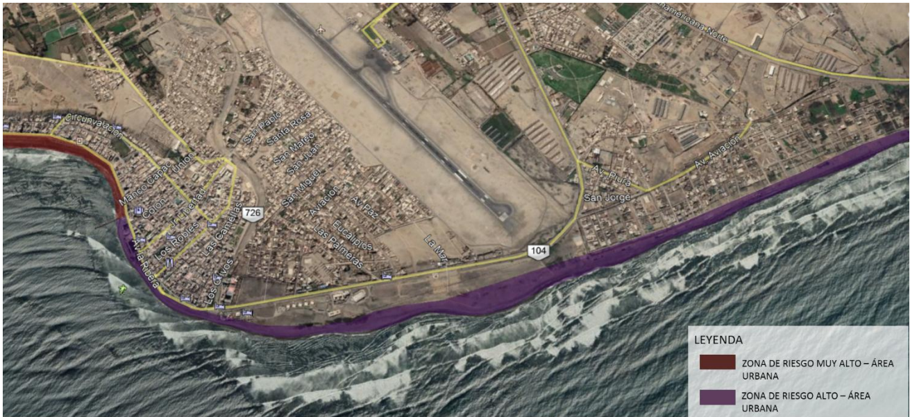
Imagen 21: Zona expuesta a erosión costera - Huanchaco Tradicional - Huanchaquito - FUENTE: SUB GERENCIA DE RIESGO Y DEFENSA CIVIL
