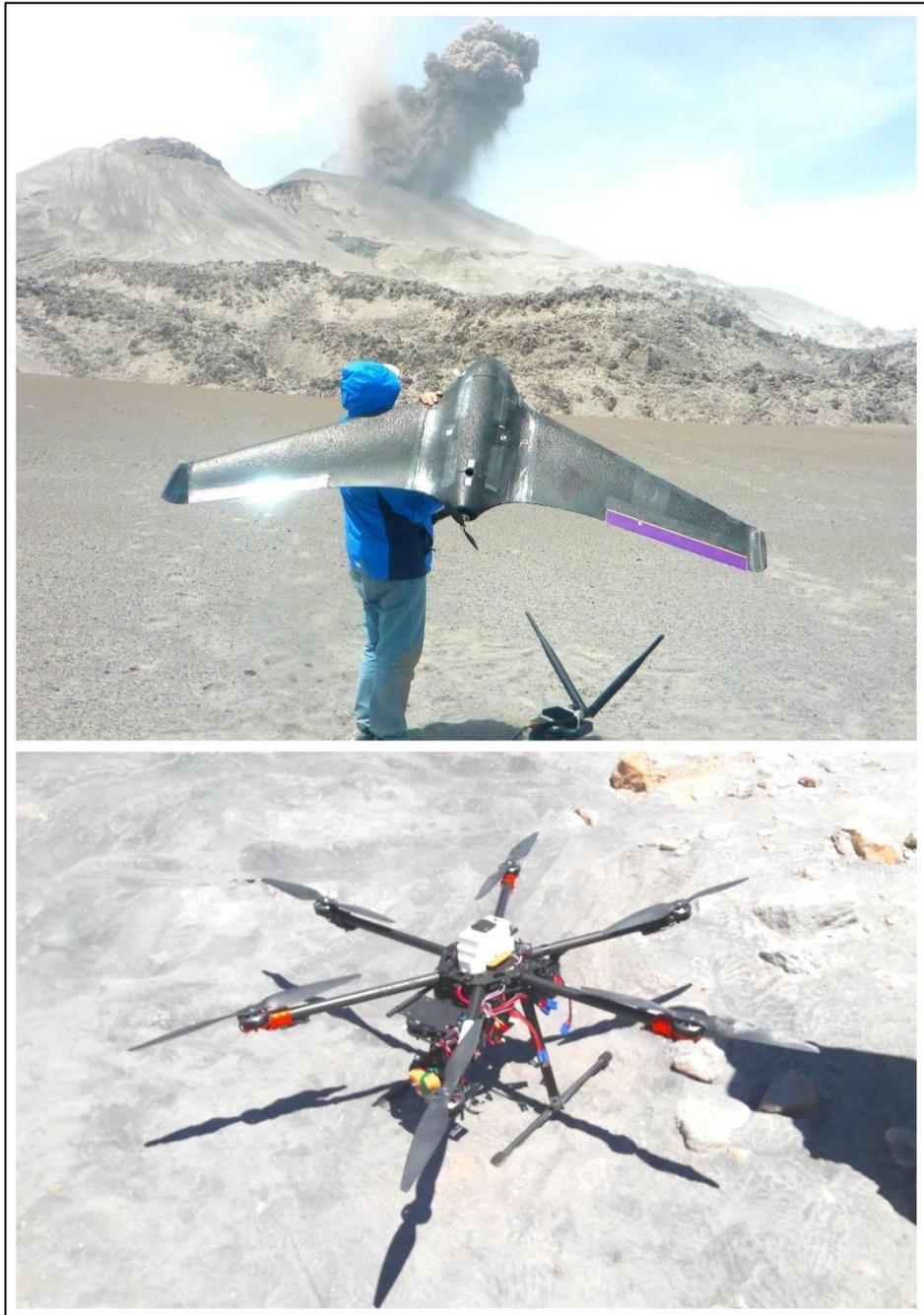
*Figura 2.- Vehículo aéreo no tripulado "Skywalker X8" (foto de arriba) y dron multirotor (foto de abajo). Ambos vehículos fueron desarrollados por el IGP.*
