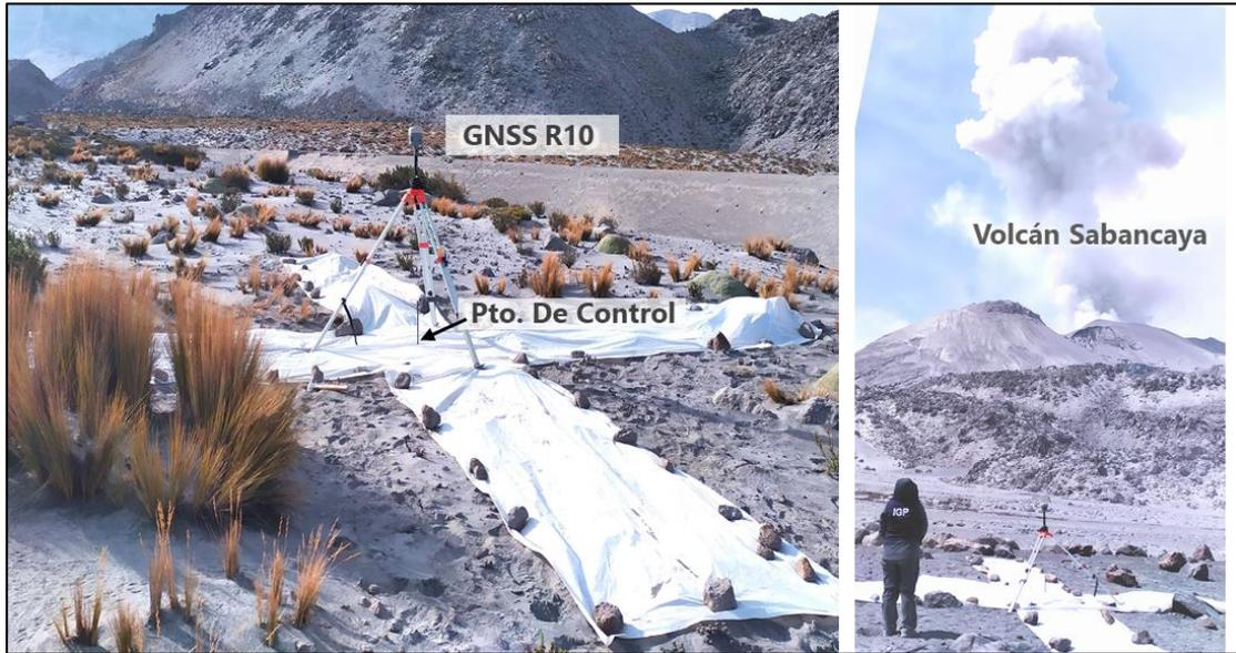
Figura 4.- Punto de control geodésico PC\_5 (izquierda) y PC\_1 (derecha). Se muestra el instrumento GNSS móvil con el cual se realiza la medición de las coordenadas del eje central del punto de control.
