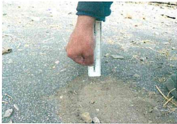
Figura 12: Medición de espesor de caída de ceniza en el sector de Escacha.
