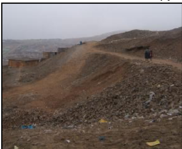
Fotos 7 y 8.- Se observa afloramientos rocosos, se observa suelo poco potente no muy desarrollado. El suelo formado esta conformado por gravas angulosas en una matriz limo-arenosa.
