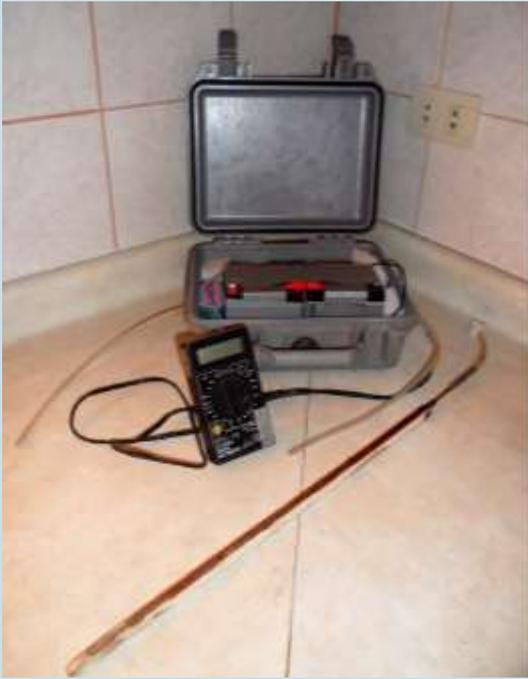
**Figura 17.** Imagen del Equipo de muestreo de CO<sub>2</sub> en el suelo
