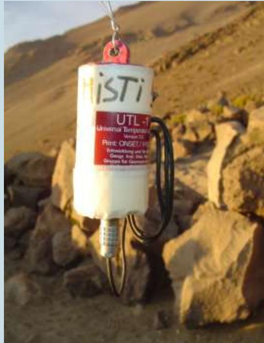
**Figura 11.** Registrador de datos de temperatura HOBO UTL-1
