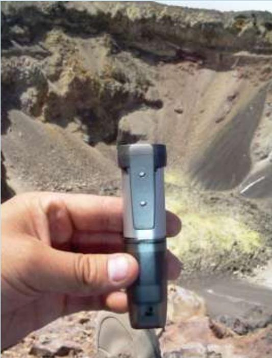
**Figura 10.** Registrador de datos de temperatura LASCAR USB EL-USB-1
