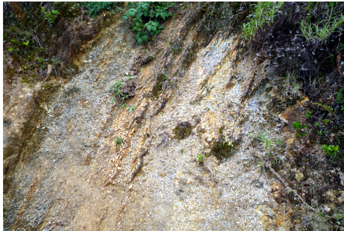
Foto 7: margas y lutitas del Grupo Qulquiñan, muy fracturados, en capas de 2 cm de grosor.
