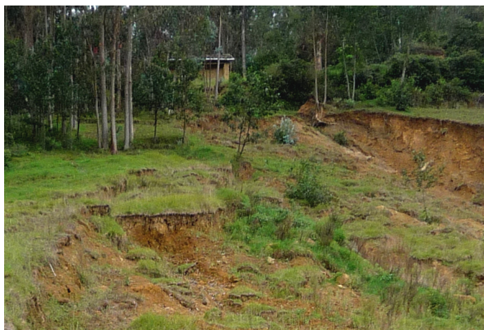
Foto 8: Cobertura de suelos color anaranjado de unos 30 cm de espesor, sobre rocas sedimentarias de lutitas y margas muy fracturadas.
