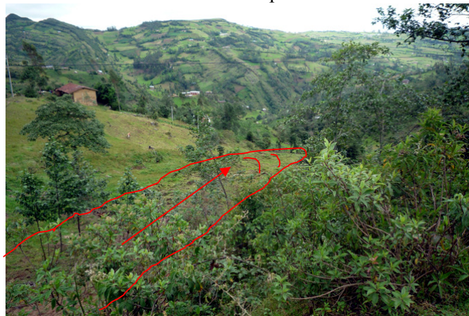
Foto 12: Vista aguas abajo de deslizamiento-flujo de tierra, que se encuentra encausado por una quebrada.
