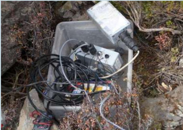
Foto N° 4. Sismómetro TITAN y Disco Duro.
