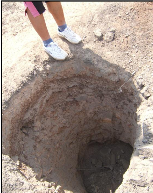
Foto 6.- Calicata de 1.50 m de profundidad, donde se muestra la roca muy alterada. Esta calicata se ubica cerca de la manzana “A”
