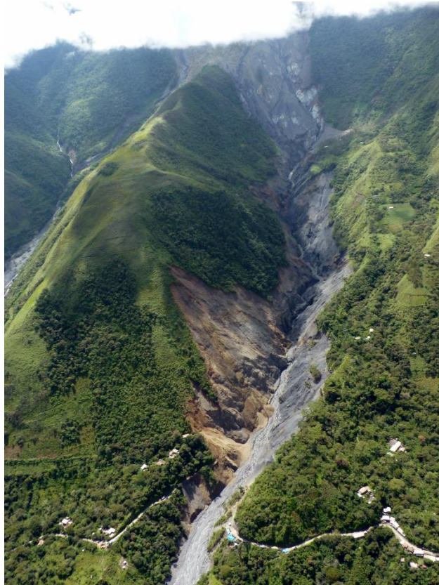
Foto 04: Vista aérea de la quebrada Puentemayo, el flujo generó varios movimientos en masas por erosión lateral.
