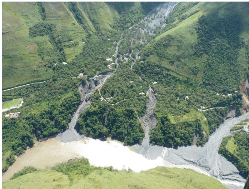
Foto 09: Vista aérea de los 3 abanicos de represamiento en el río Vilcabamba y la laguna consecuyente.
