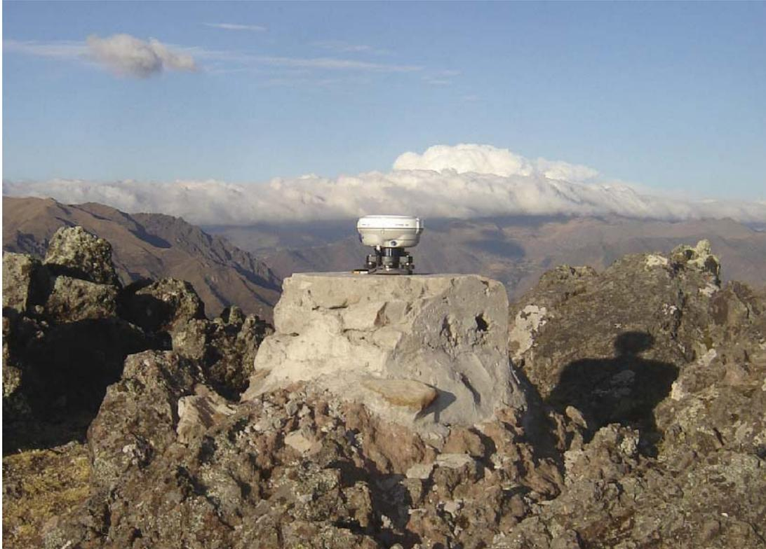
**Fotografía 8.1** Ejemplo de estación geodésica o hito geodésico empleado para el monitoreo de las fallas activas en la región Cusco. En la foto se muestra la estación QORI, cerca de la laguna Qoricocha, ocupada por un GPS diferencial de doble frecuencia.
