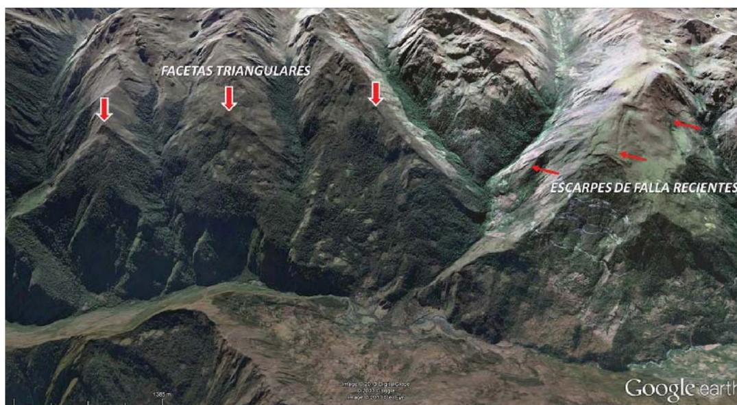
**Figura 4.42** Facetas triangulares de hasta 150 metros, a la derecha se pueden observar escarpes mejor conservados. La morfología de estos escarpes nos indica actividad reciente y acumulación de varias reactivaciones de la falla.
