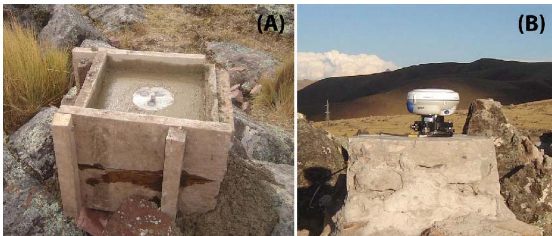
**Fotografía 8.2** Hito geodésico tipo I. (A) Hito en construcción. (B) Ocupación del hito con el GPS Trimble R6.
