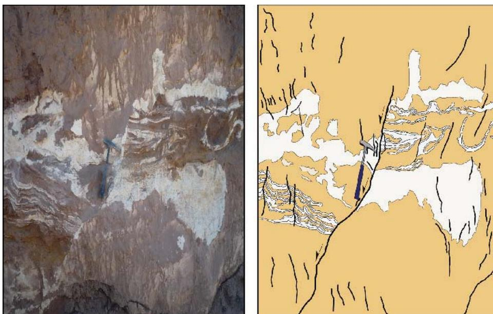
**Figura 3.13** Falla normal post-*slump* afectando depósitos lacustres y diatomitas de la formación San Sebastián. A la izquierda se observa la interpretación dando idea del desplazamiento vertical de tipo normal de la falla (0.60 metros).
