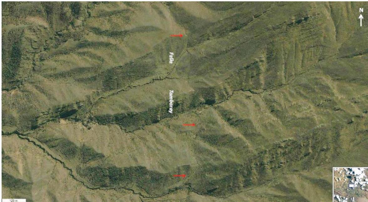
**Figura 4.9** Sector norte de la falla Tamboray donde se observa el desplazamiento vertical y la variación lateral de los cursos de los ríos por efecto del movimiento de rumbo sinistral.
