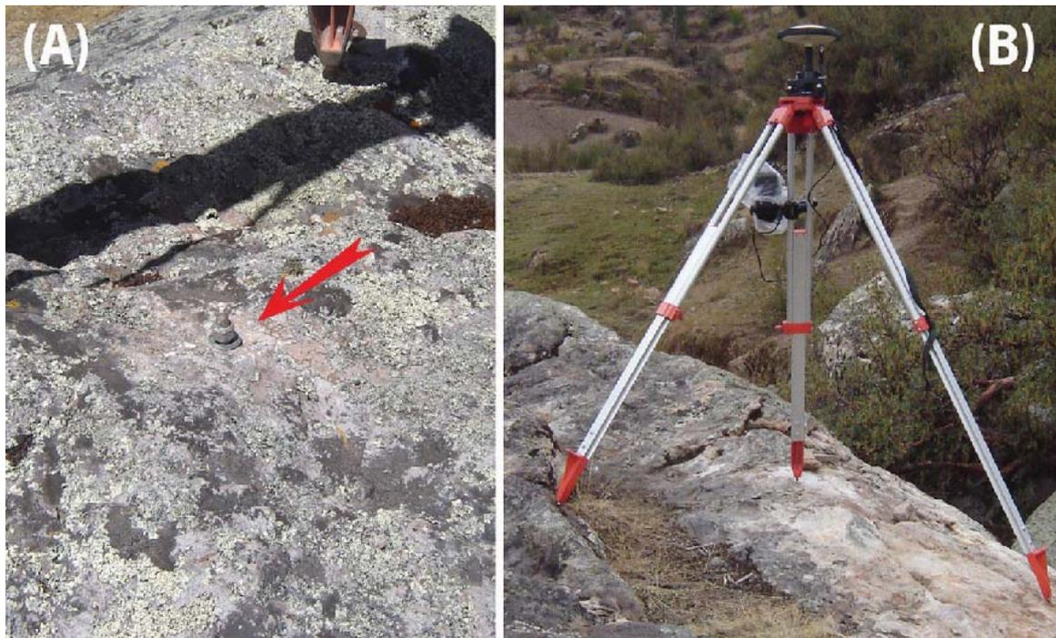
Figura 8.8 Puntos de control para la red de monitoreo del deslizamiento de Cuyo Chico. (A) Perno de expansión instalado en roca. (B) Ocupación de un punto de control con el GPS THALES Promark3.
