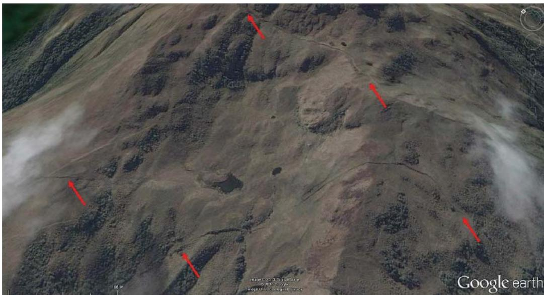
**Figura 4.41** Escarpes de falla conservados en la parte alta del cerro Conoorcco, entre las localidades de Choquecancha y Colca.
