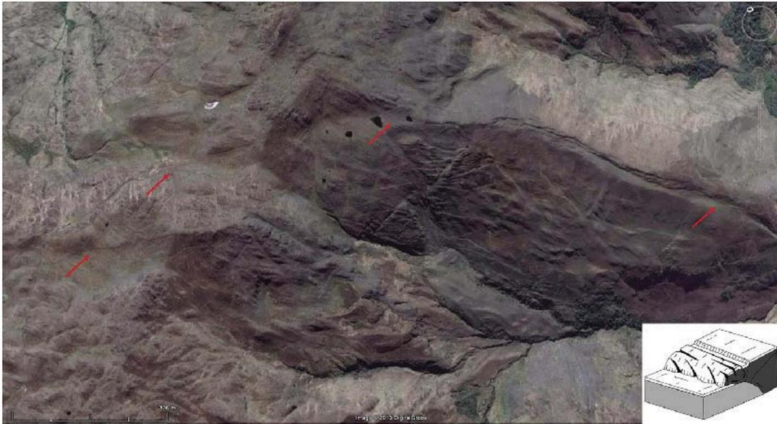
**Figura 4.37** Escarpes de fallas, bien conservados, frente a la localidad de Paucartambo. Se trata de fallas inversas con escarpes paralelos secundarios asociados a la propagación.
