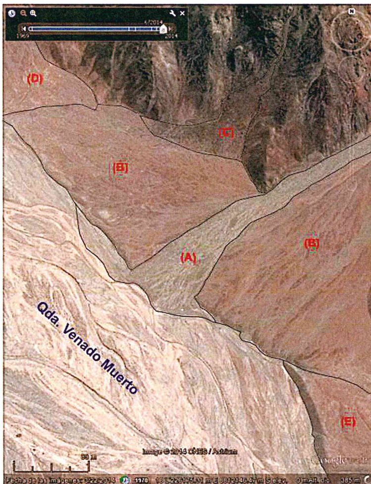
Figura 7. Margen derecha de la quebrada Venado Muerto, se aprecia los depósitos recientes (A) y antiguos (B), (C); (D) y (E).
