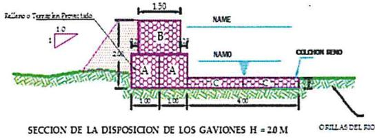
COMO SE OBSERVA LA FIGURA DE 2 PISOS LAS CARACTERISTICAS GEOMETRICAS DE LOS GAVIONES SON:
