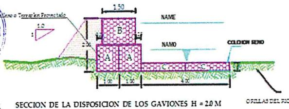
SECCION DE LA DISPOSICION DE LOS GAVIONES H = 2.0 M
