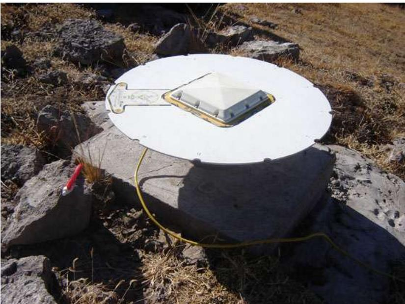
**Foto13.** GPS Geodésico, marca Trimble, modelo 4000SSE.
