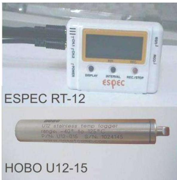
**Foto 1.** Registradores de temperatura ESPEC instalado en septiembre de 2005, HOBO U12-15, instalado en febrero de 2007 en la fuente UBT.
