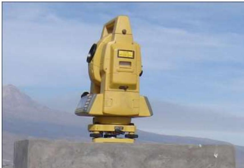
**Foto 11-** Estación Total empleada en el monitoreo de deformación del volcán Ubina. Marca Topcon modelo GPT8002A
