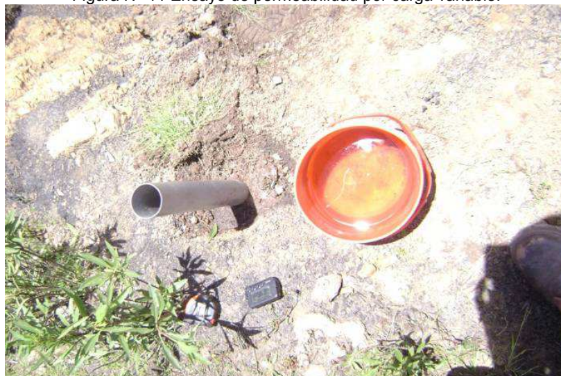
Figura N° 11 Ensayo de permeabilidad por carga variable.
