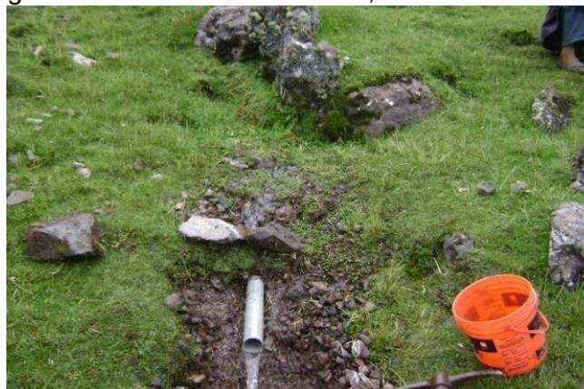
Figura N° 15 Aforo de manantes, método volumétrico
