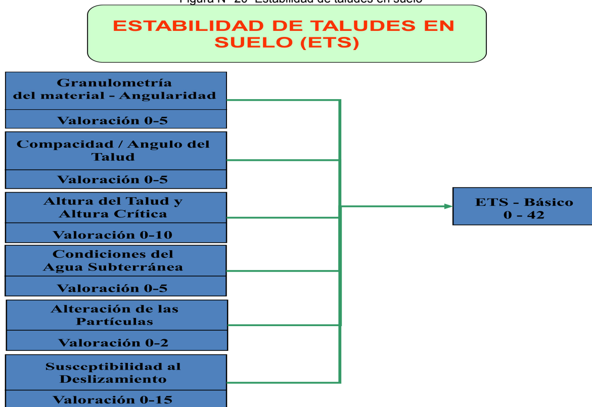
Figura N° 20 Estabilidad de taludes en suelo
