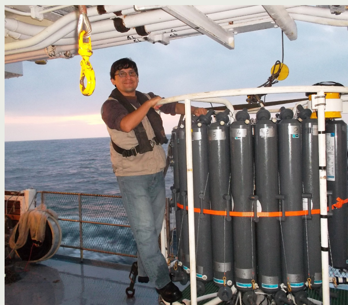
Kobi Mosquera en plena preparación de la Roseta con botellas Niskin para obtener muestras de agua en 22 profundidades distintas. Asimismo, esta plataforma contiene el CTD (ubicado en la parte inferior central) y dos ADCPs (uno de ellos se observa en la parte superior de la roseta de color amarillo). El lanzamiento del CTD se hace cada tres horas y puede durar entre 40 minutos y hora y media (descenso y ascenso), dependiendo de la profundidad en la que se encuentre el barco.
