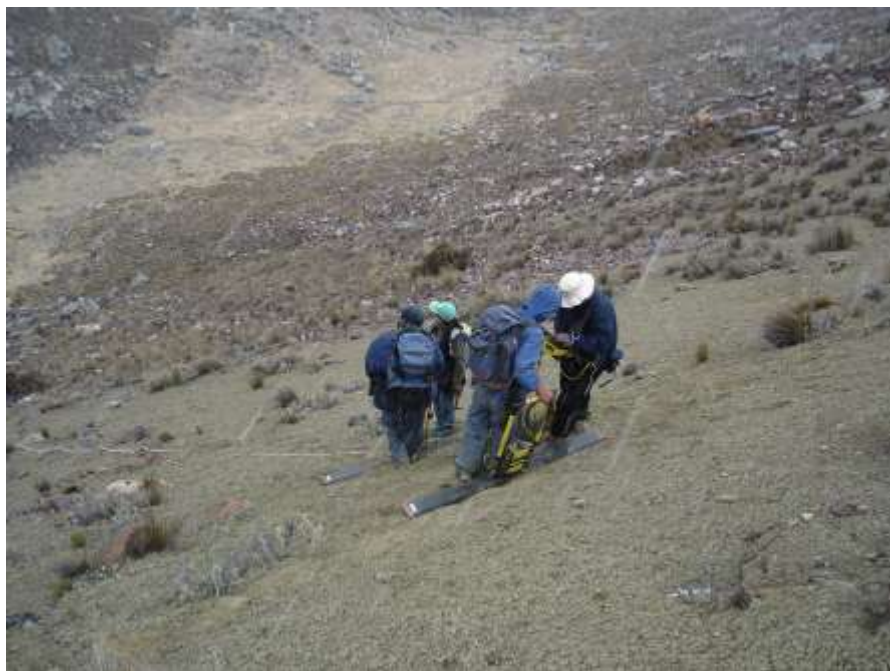
Foto 6.1: Prospección geofísica en la morrena lateral izquierda, se observa las dos líneas transmisoras en forma paralela.
