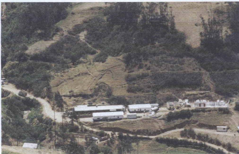
Foto N° 14 Vista del área afectada por deslizamiento en enero de 1986, adyacente a la relavera El Churge, detonado por saturación y fuertes lluvias pluviales; actualmente sujeta a erosión fluvial en la margen izquierda del río Laclambay
