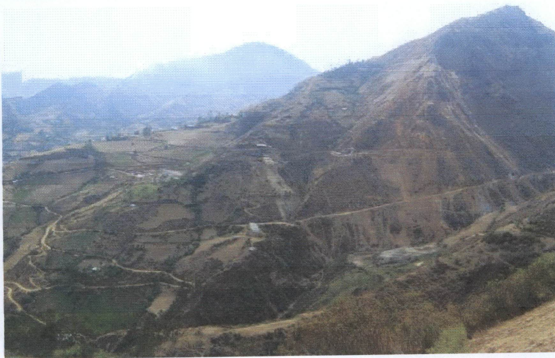
Foto N° 29 Vista del cerro Mulaya (ladera Oeste y noroeste), que muestra la actividad minera informal de la zona como la construcción de nuevos accesos (carreteras); estas actividades generan material que es arrojado en las laderas o taludes llegando hasta el piso de valle, representando un peligro latente para la generación de movimientos en masa.
