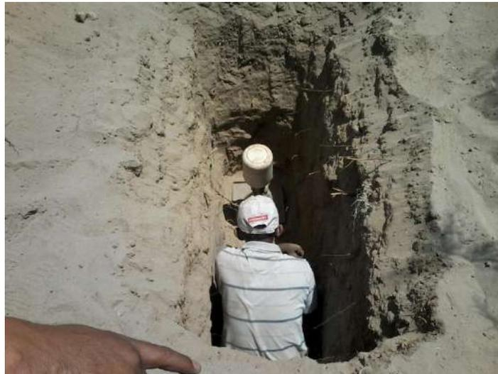
**VISTA DE EJECUCION DE ENSAYO DE DENSIDAD DE CAMPO**
