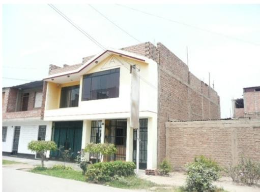
Figura 49. Vivienda de albañilería confinada con techo aligerado
