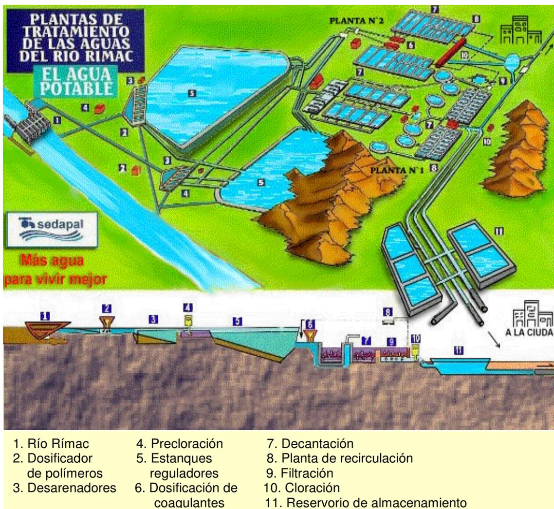
Figura 361. Esquema de la planta de tratamiento de la Atarjea
