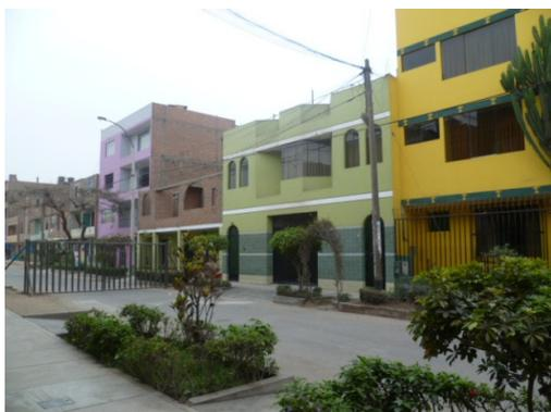
Figura 32. Viviendas típicas, de 2 a 3 pisos en base a albañilería confinada
