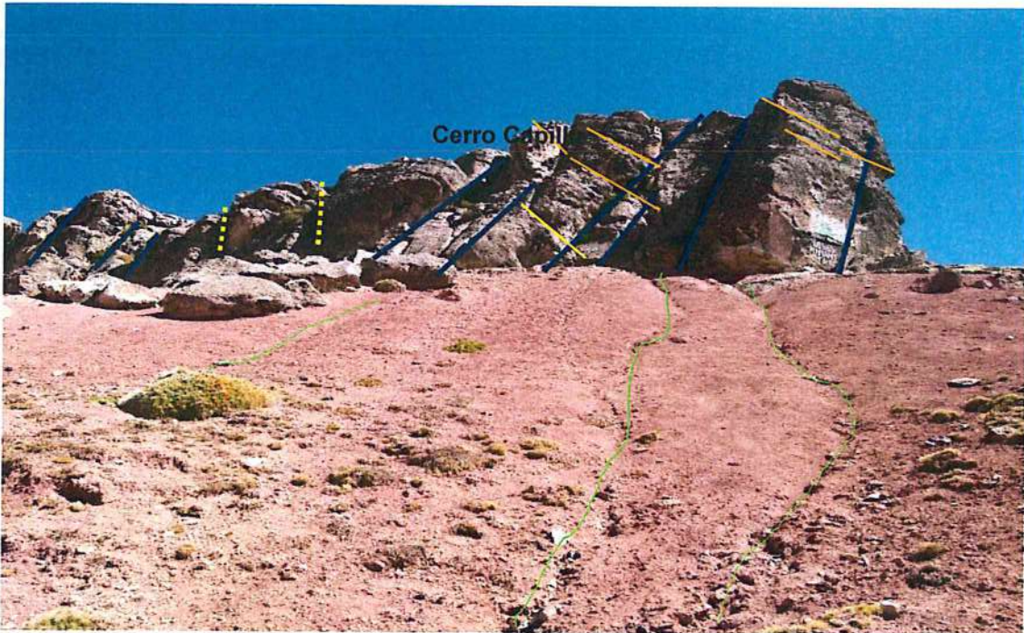
Figura N° 14, Afloramiento rocoso con sistema de fracturas de 03 familias la más persistente en línea azul y algunas fracturas de la familia 2 (líneas amarillas) y la tercera familia en líneas punteadas y en línea verde erosión de ladera.
