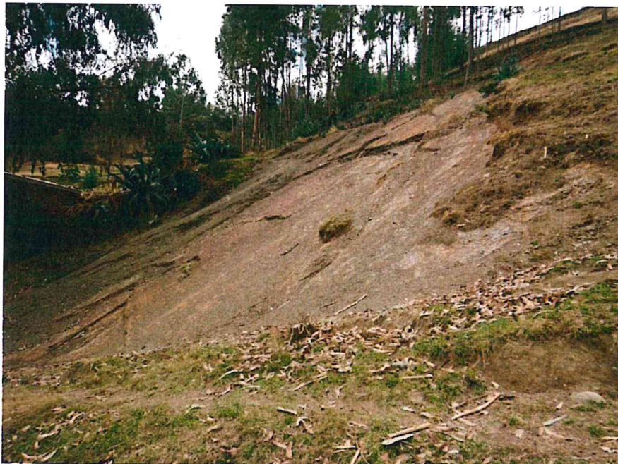
Fotografía 4: Obsérvense capas estratificadas de arcillitas (parte de la Formación Santa) de: Rb: N15° y Bz: 50° (o inclinación de 50°).
