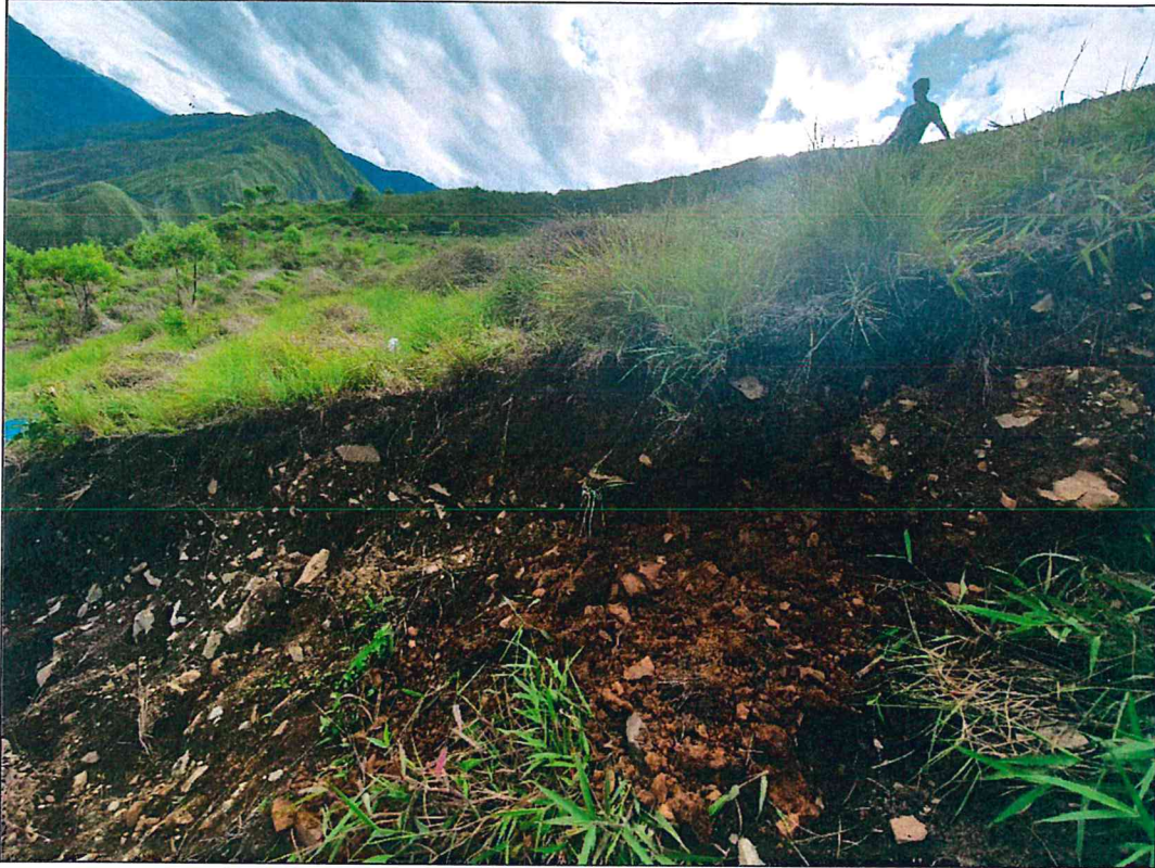
Fotografía 1. Material coluvial (pizarra y arcillas) en el cuerpo del deslizamiento del cerro San Valentín- Quilcapata.
