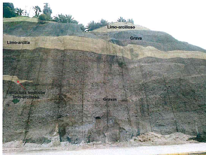
Figura 3: Vista con dirección al oeste donde se diferenciaron los niveles de material grueso y fino que forman el acantilado de la Costa Verde.
