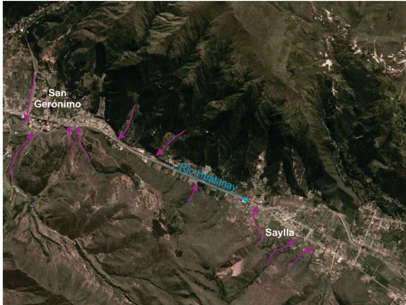
Figura 3: Cauce del río Huatanay entre los poblados de San Gerónimo y Saylla, donde se producen erosión fluvial e inundación; se señalan con flechas color lila las quebradas por donde discurren flujos de detritos.
