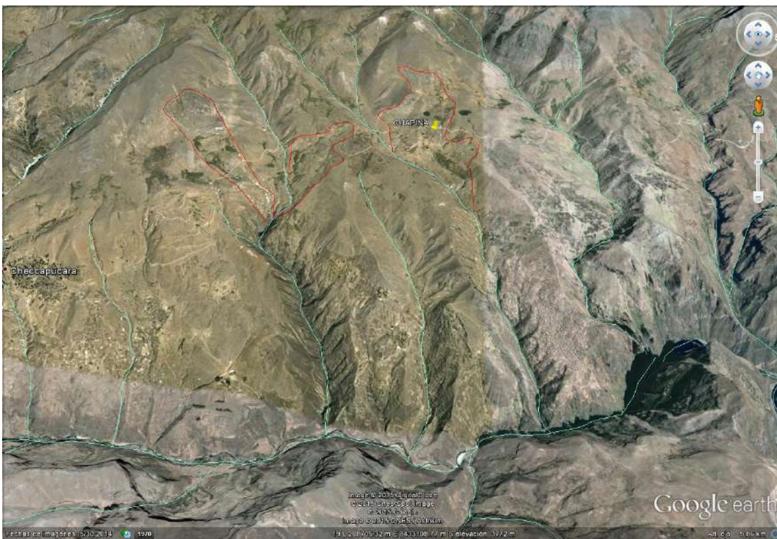
Figura 17: Limites aproximados de los deslizamientos activos en los sectores de Chapina e Irobamba, delineados con líneas rojas.
