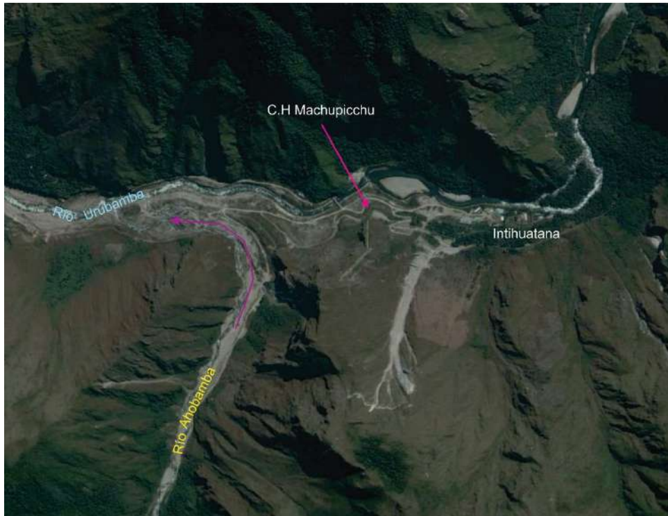
Figura 7: Vista del río Urubamba donde se encuentra la C.H de Machupicchu, también se puede observar el cauce del río Ahobamba, por donde discurrió un aluvión que represó el río Urubamba y provocó daños en la central hidroeléctrica.
