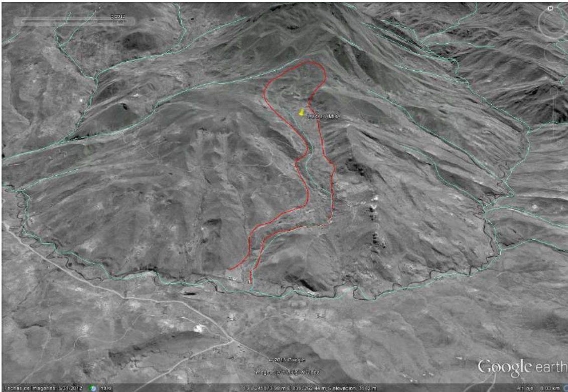
Figura 23: Imagen Google Earth donde se delimito el flujo de tierra de Jarabamba (línea roja), en la imagen también es posible observar otros eventos de flujos de tierra de menor dimensión en el lado izquierdo del señalado.
