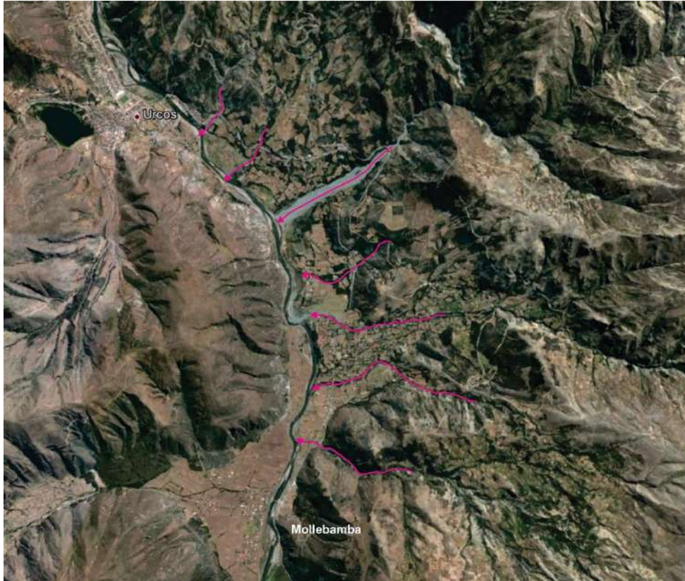
Figura 11: Tramo de carretera entre Urcos y Molebamba cruza varias quebradas activas por donde discurren flujos.
