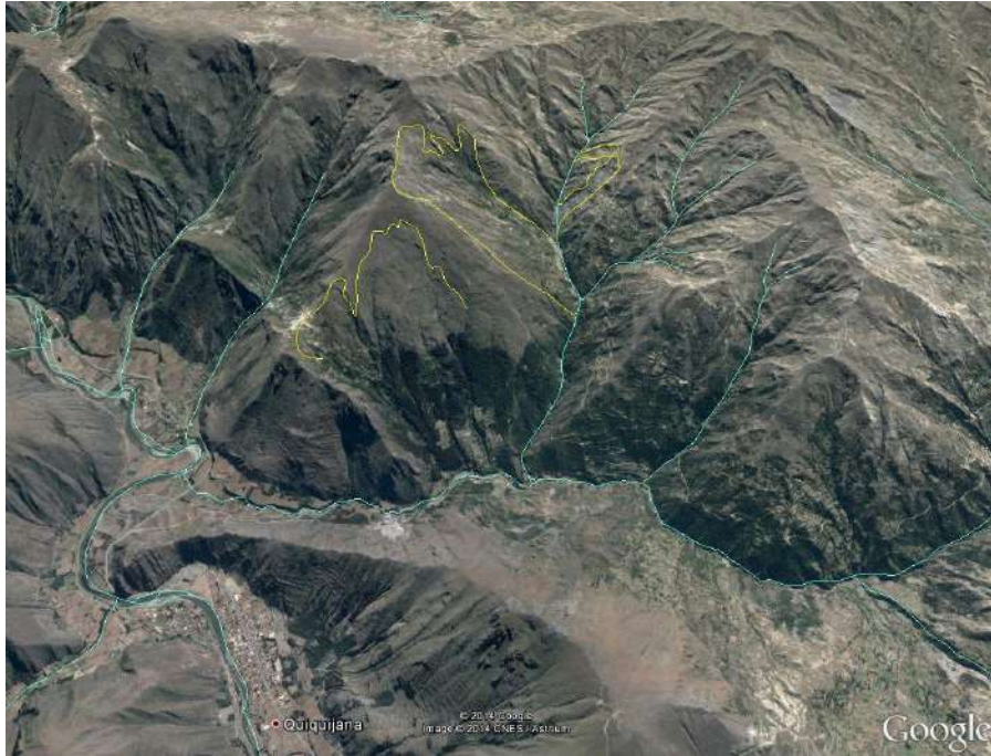
Figura 13: Quebrada Chullo, se han señalado con líneas de color amarillo las zonas de arranque de eventos activos en la quebrada.
