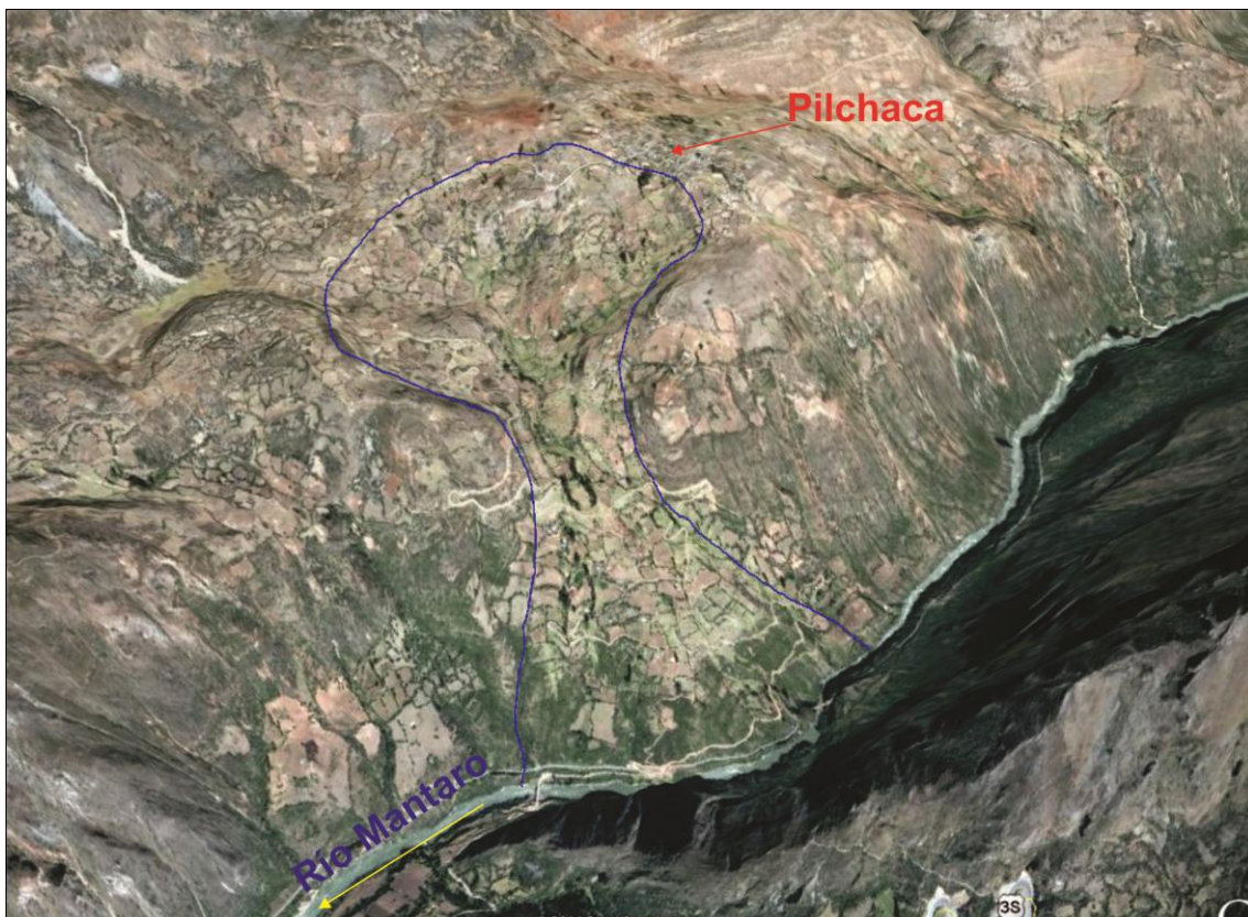
Figura 4: Vista del deslizamiento-flujo de tierra de Pilchaca, se puede observar que ha desviado el río Mantaro hacia su margen izquierda.
