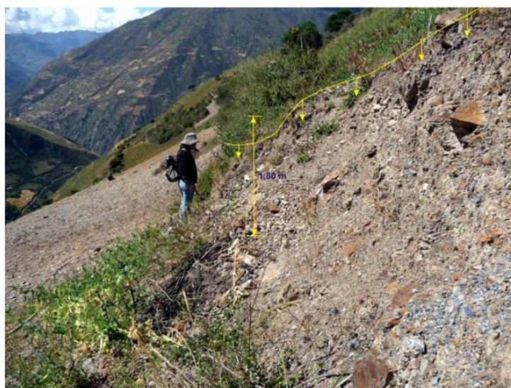
Foto 38: Vista hacia el sureste, sector de Casay, donde se puede observar el salto principal del deslizamiento de 1,8 m.
