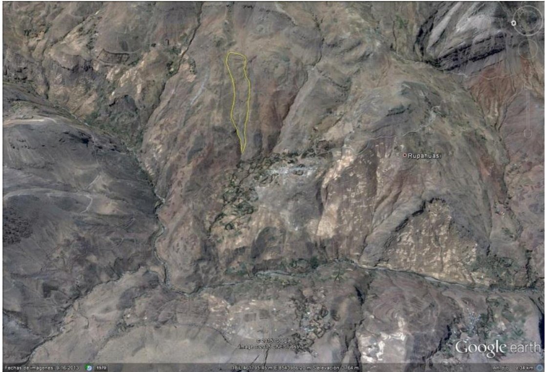
Figura 7: Vista hacia el este, donde se señala con línea amarilla el deslizamiento activo frente a la comunidad de Cochas.
