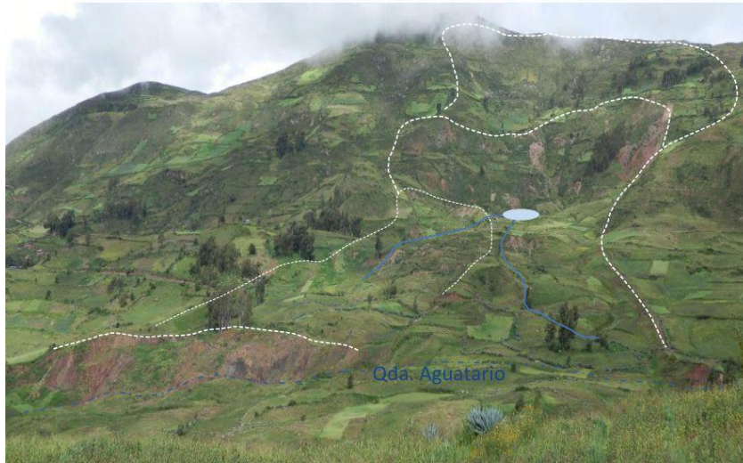
Foto 46: Deslizamiento rotacional de escarpas multiples y sucesivas en el sector yanayacu-Cutmo, Lacroja.
