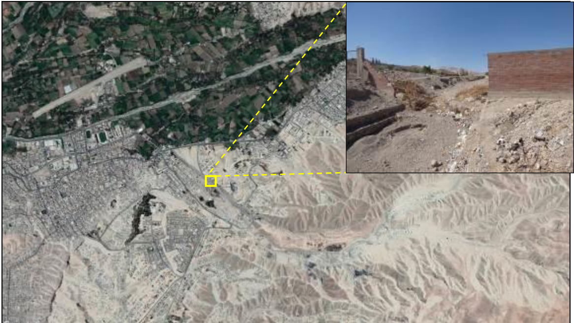
Figura 5. Imagen satelital Google Earth, donde se aprecia el cauce de la quebrada El Cementerio reducido.
