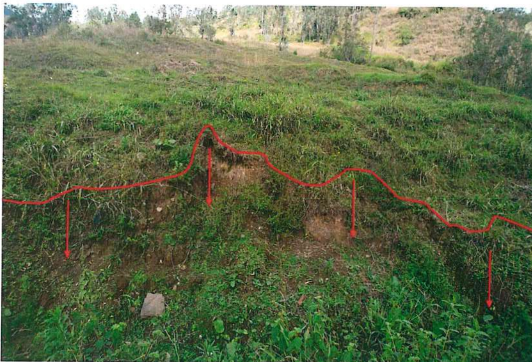
Figura 7: Secuencia de desplazamientos verticales en la ladera evaluada sobre el pueblo de Pulán,
