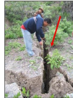
2 Sector Chua, se muestra los agrietamientos del terreno, presentan profundidades visibles hasta de 3 m., (A) desplazamiento vertical, (B) desplazamiento horizontal.
