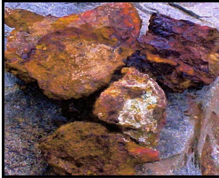
**Foto N° 71:** Coluvio local de Gossan con contenidos jarositicos, hematiticos y carbonatos de Cu extraído del afloramiento del Stringer Ore.
