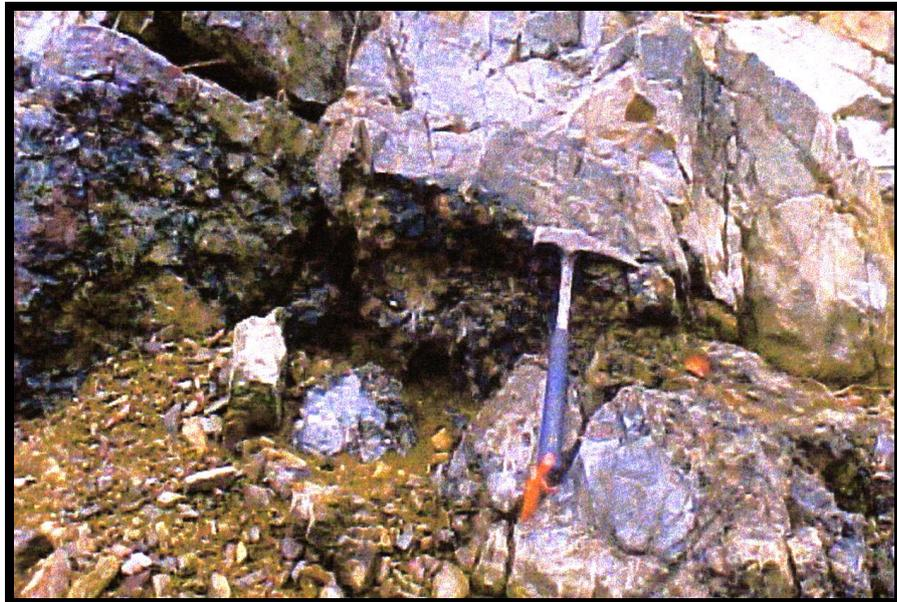
**Foto N° 70:** Brecha suprayacente al stringer ore, contiene clastos de composición dacítica con alteración sericítica
