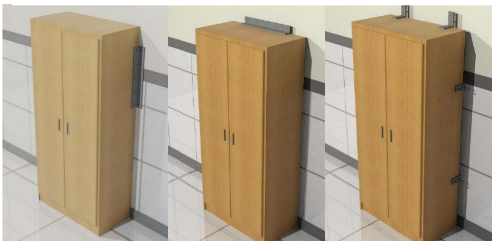
Figura 9.4 Muebles y armarios deben estar fijados y asegurados afín de evitar caídas que afecten al personal de salud o que obstruyan salidas o corredores de evacuación. .
