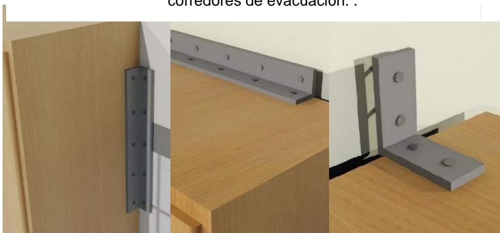
Figura 9.5 Los sistemas de aseguración pueden ser de diferentes tipos, en las zonas laterales o partes superiores, el objetivo es contar con puntos de sujeción ante volcamientos o caídas.
