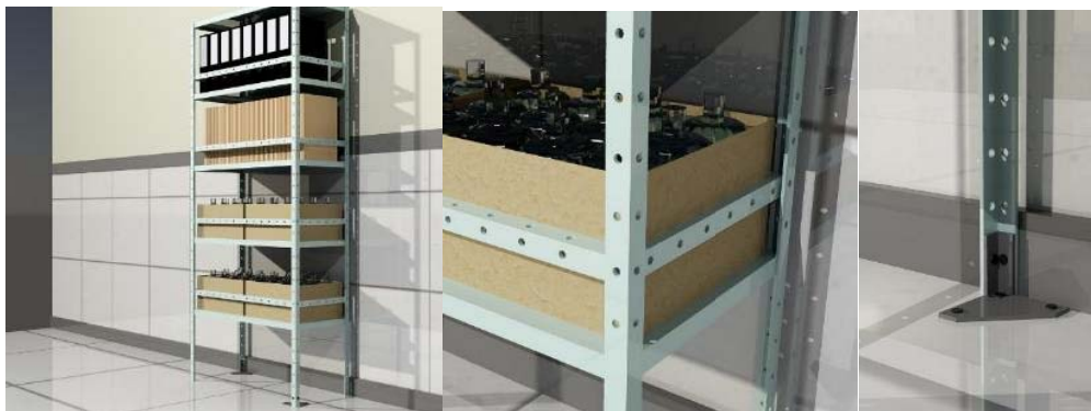
Figura 9.10 Sistema de aseguramiento de las unidades almacenadas en las estanterías, se evita caída de estanterías y desplazamiento y caída del contenido.
