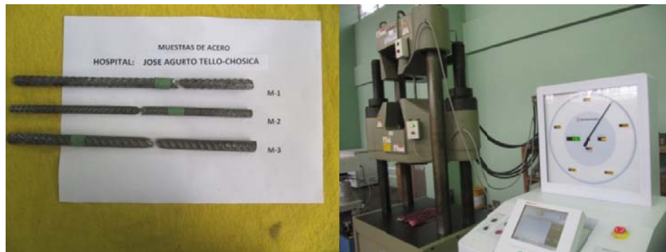
Foto 19. Máquina de ensayo y muestras de acero antes y después del ensayo a tracción
