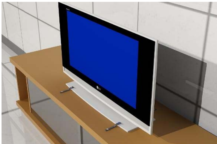
Figura 9.6 Formas de asegurar equipos electrónicos, mediante seguros de correas
