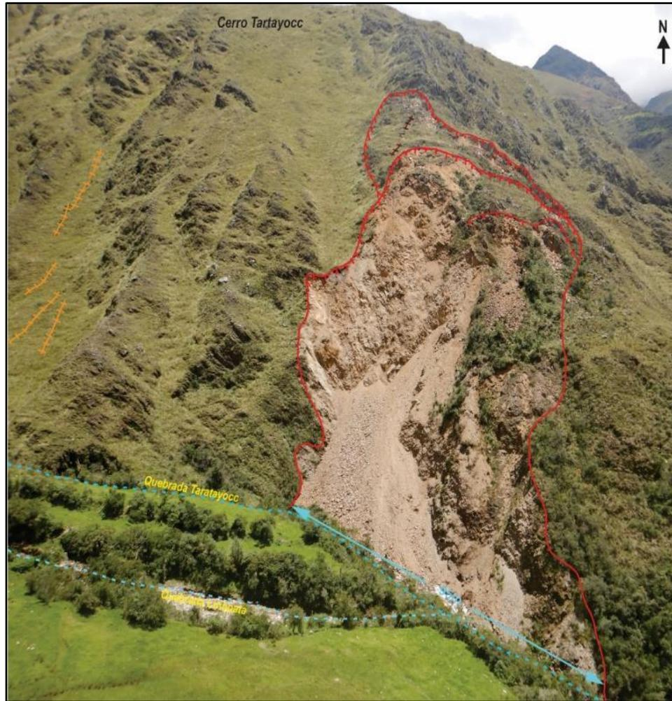
**Figura 11.** Vista del derrumbe (líneas de color rojo) en laderas del cerro Tartayocc, con dimensiones de 64 m de ancho y altura entre el escarpe y el pie de 105 m, y presencia de grietas longitudinales (líneas de color naranjas). Se encuentran en las siguientes coordenadas UTM N8654804, E498015, con una elevación de 3623 m s.n.m.
