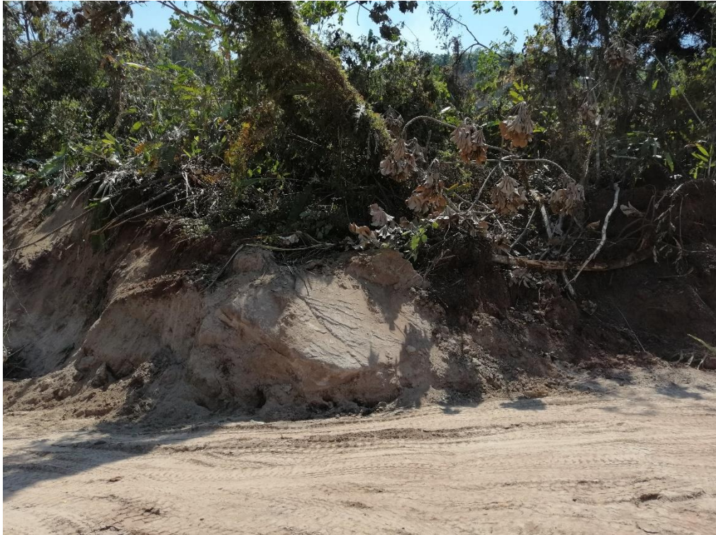
Fotografía 5: Mega bloque de 2.0 m de diámetro de roca arenisca inmerso en la masa deslizada.
