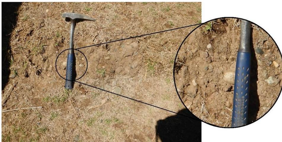
**Figura 3.** Se aprecian gravas subangulosas, en una matriz limoarcillosa, que componen el material detrítico en la base de los depósitos morrénicos.
