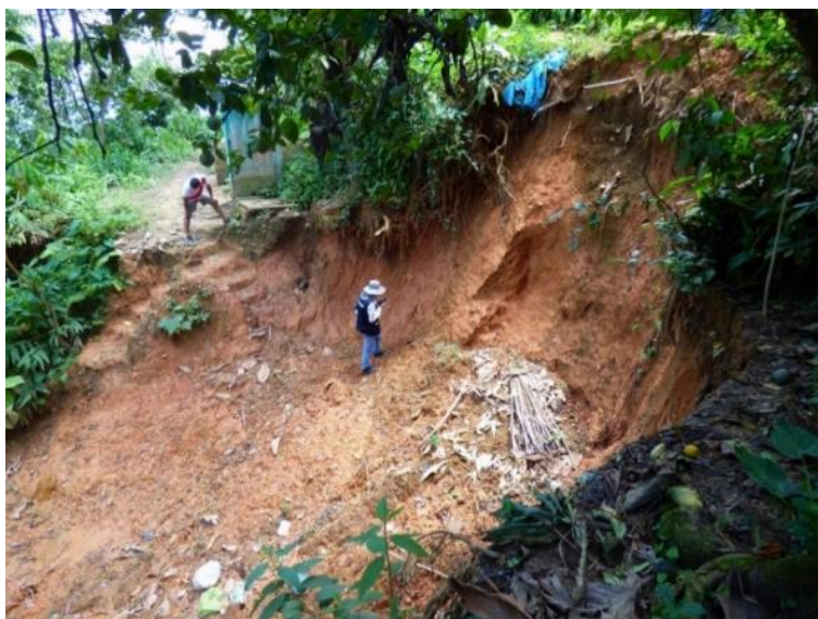
Fotografía 5. Los afloramientos de rocas sedimentarias tipo conglomerados (clastos de rocas intrusivas, areniscas cuarzosas rojas y areniscas feldespáticas, envueltas en matriz limosa) que se encuentran muy meteorizadas. Vista al norte.
