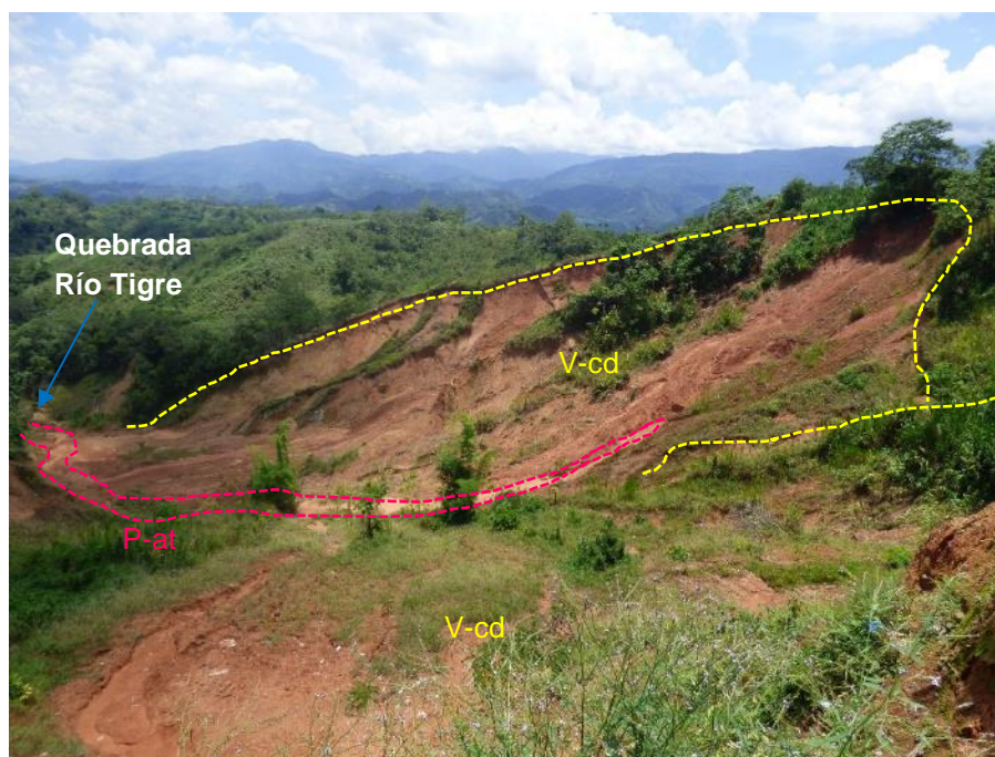
Figura 5. Vista al noreste de la quebrada Río Tigre donde se identificaron piedemontes aluvio-torrenciales (P-at) y coluvio-deluviales (V-cd).
