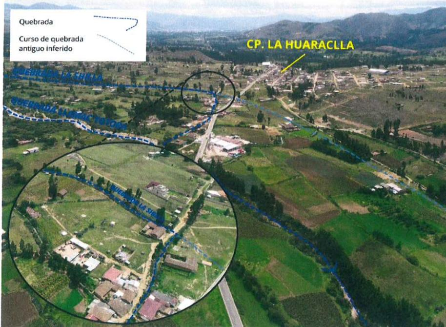
Figura 16. Fotografía aérea mostrando un cambio de dirección brusca de la quebrada la Shilla, canalizada hacia la quebrada Llamac-Totora.
