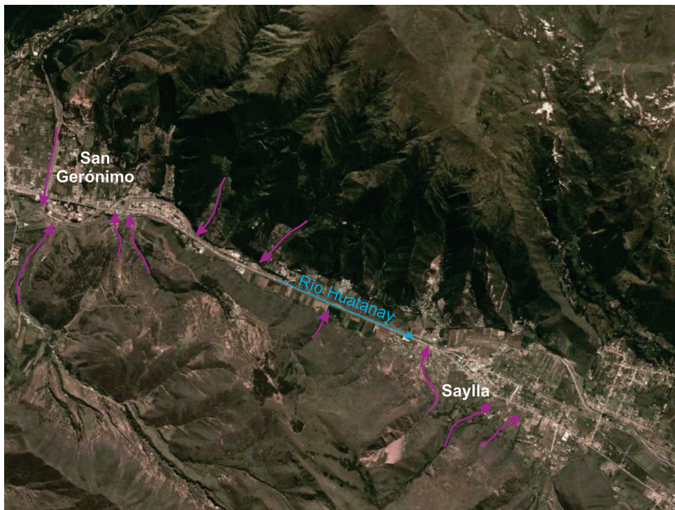
Figura 8.4 Cauce del río Huatanay entre los poblados de San Gerónimo y Saylla, donde se producen erosión fluvial e inundación. Se señalan con flechas color lila las quebradas por donde discurren flujos de detritos.
