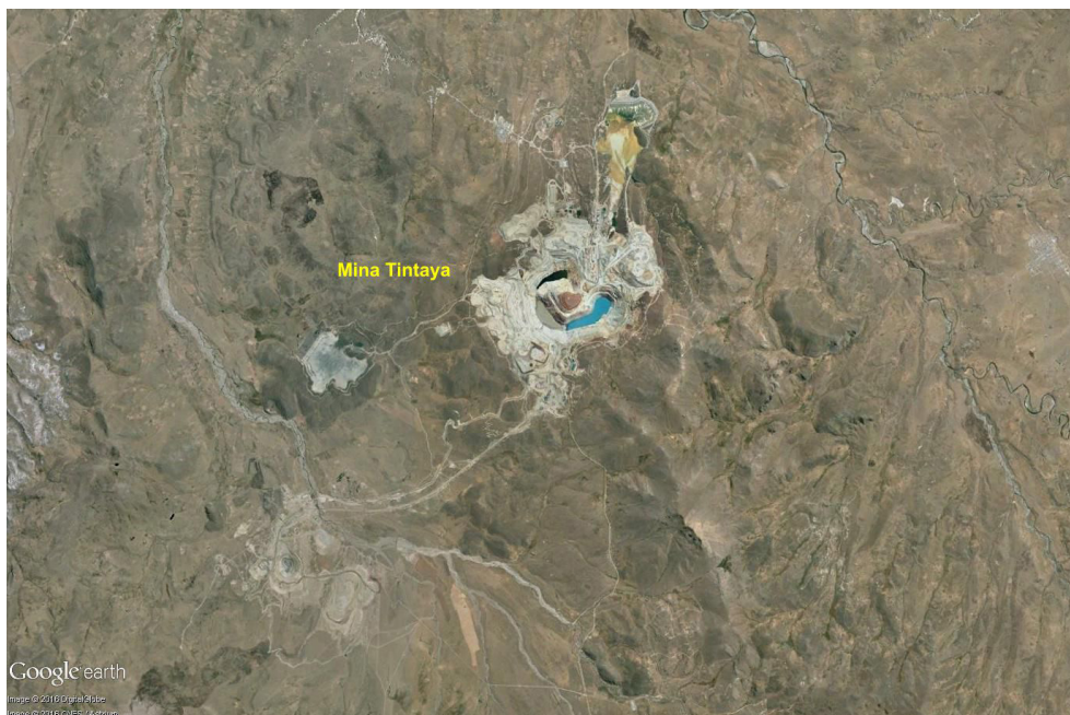
Figura 5.16 En la imagen de Google Earth se pueden observar el tajo abierto, los desmontes y presas de relave de la mina Tintaya, distrito de Espinar.
