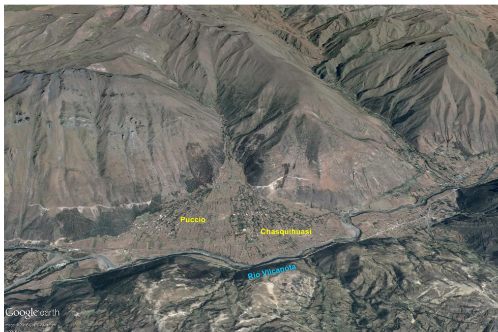
Figura 5.14 Abanico aluvial formado por la quebrada Moccorayse, sobre este depósito se asientan los poblados de Chasquihasi y Puccio, en la margen izquierda del río Vilcanota, distrito Cusipata.
