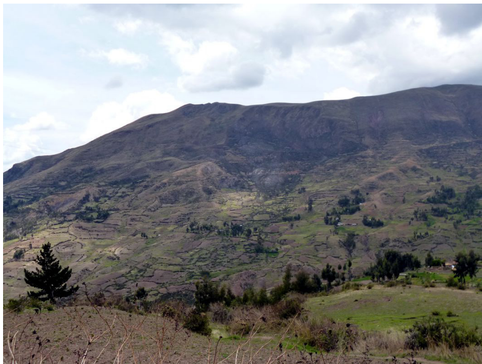
Fotografía 8.93 Deslizamiento rotacional antiguo reactivado en el cerro Jachi, produce asentamientos en la plataforma de la carretera.
