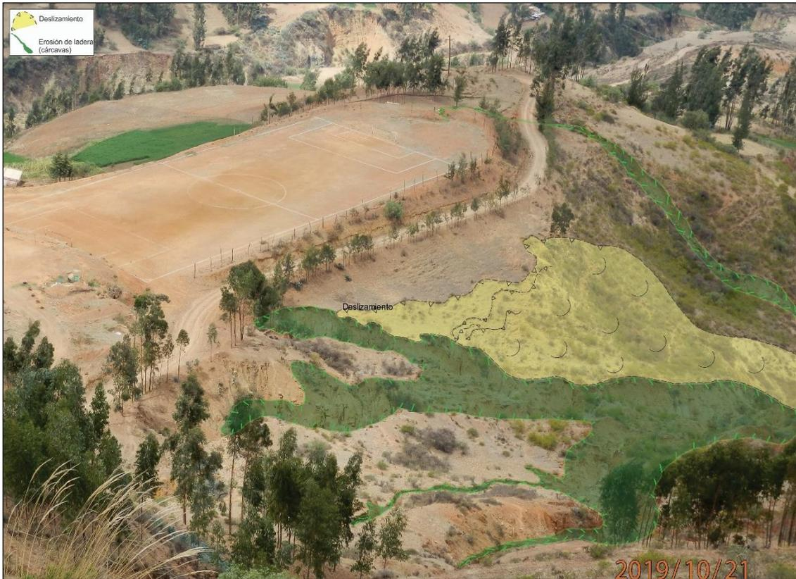
**Figura 9.** Vista al norte, donde se puede visualizar deslizamiento de tipo rotacional, con escarpas continuas, tiene un desplazamiento entre la escarpa al pie de la misma de 36m, cubierta por pastos y próximo a la trocha. Erosión de laderas en ambos márgenes del deslizamiento.
