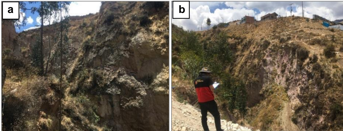
Figura 21. a) Escarpas de deslizamientos antiguos, con pendiente >45^\circ , la vivienda más cercana se encuentra a 50 m. b) Cárcava con pendiente entre 40-45^\circ , ubicada a 100 m de la vivienda más cercana. Se observa también la presencia de árboles inclinados.
