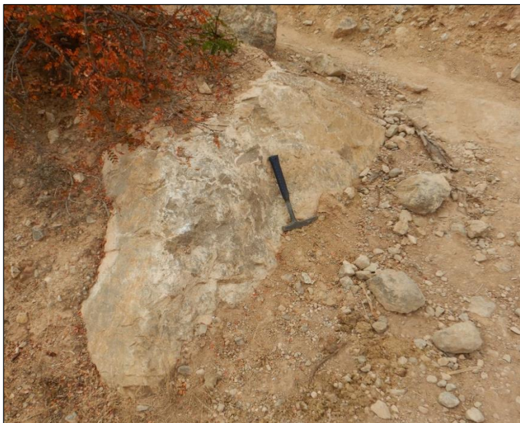
Fotografía 2. Vista donde se observa estrato rocoso de caliza, de color gris con presencia de calcita; se ubica en las coordenadas UTM 8772189 N, 278004 E a una altitud de 2761 m s.n.m.
