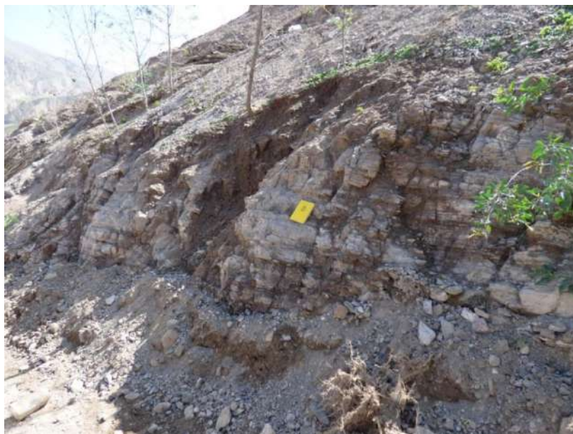
Fotografía 1: Afloramiento de lavas muy fracturadas y alteradas de la Formación Huaracane, en la prolongación de la calle La Portada de la Asociación de Vivienda Prolongación.
