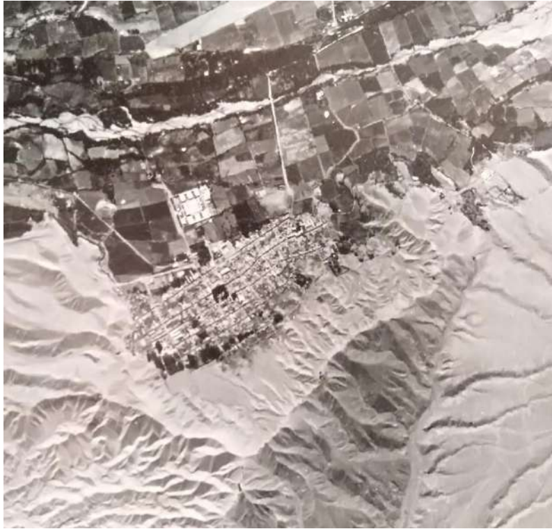
Figura 24: Foto aérea del año 1955, se puede observar el centro urbano de Moquegua, las viviendas se encuentran principalmente al pie y parte media de la ladera noroeste del cerro Cruz del Siglo; obsérvese también los piedemontes deluviales depositados por flujos de detrito y lodo no encauzados. (fuente: Servicio Aerofotográfico Nacional).
