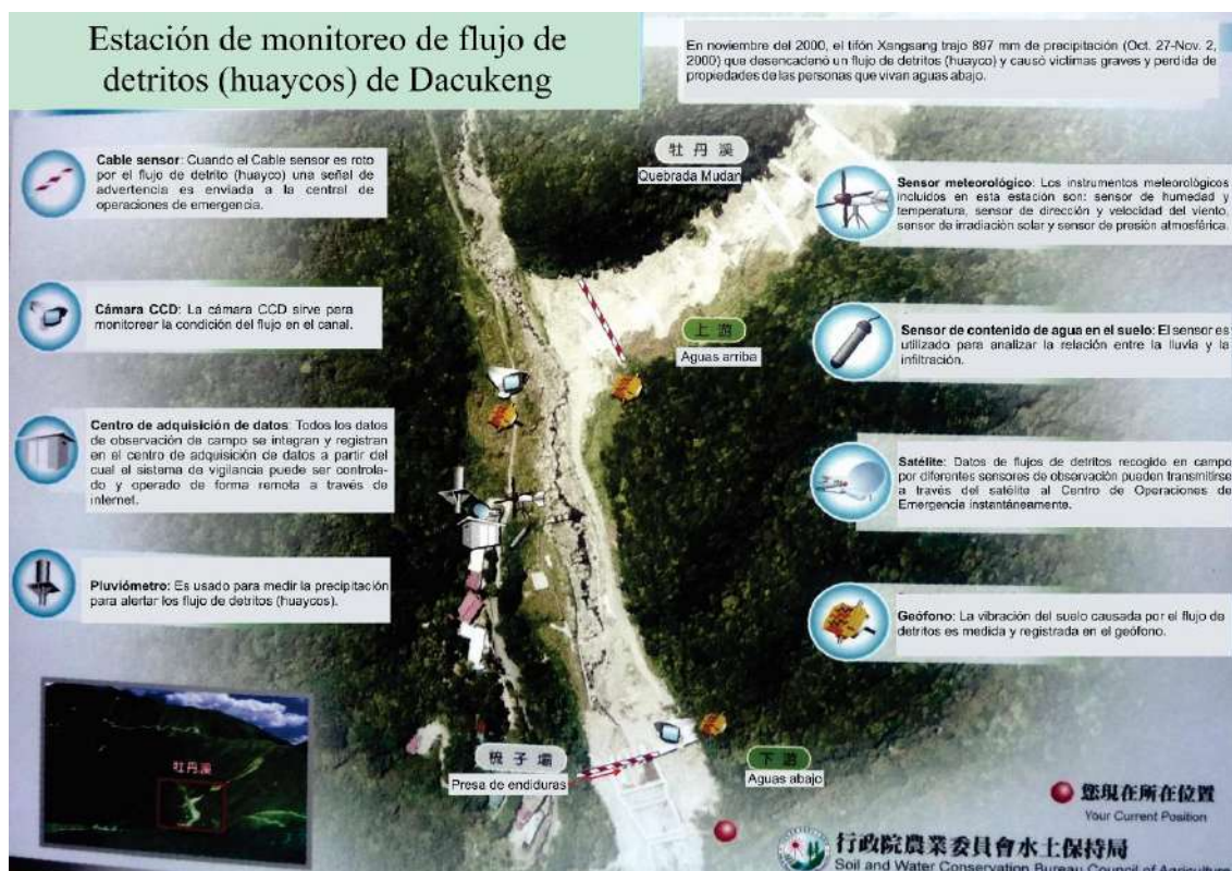
Figura 48: Esquema de los equipos que deben conformar una estación de monitoreo de flujo de detritos y/o lodo. (Fuente: Soil & Water Conservación Bureau, COA. Taipei, Taiwan, 2010).
