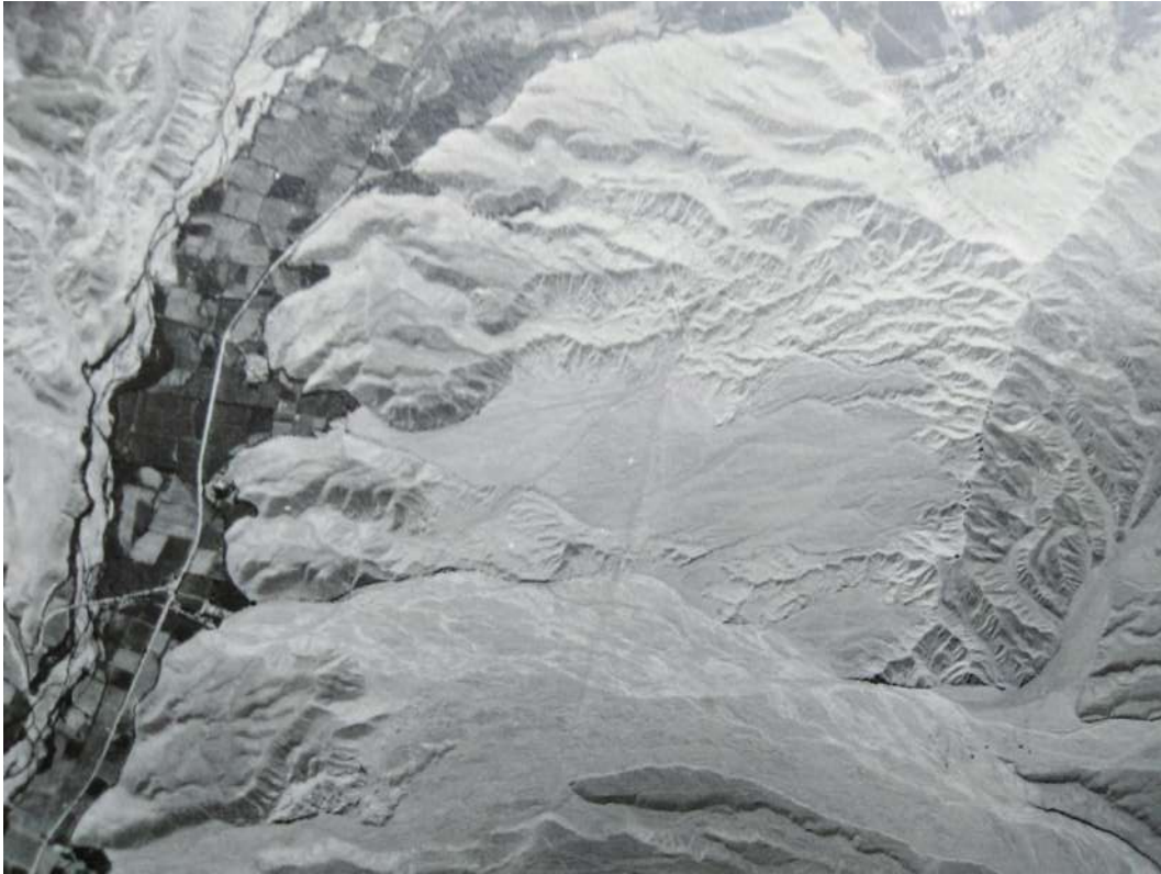
Figura 26: Foto aérea del año 1955, se puede observar los piedemontes aluvio-torrenciales que bajan de la ladera oeste del cerro Cruz del Siglo, estos depósitos son ocupados actualmente por el sector de San Antonio. (fuente: Servicio Aerofotográfico Nacional).
