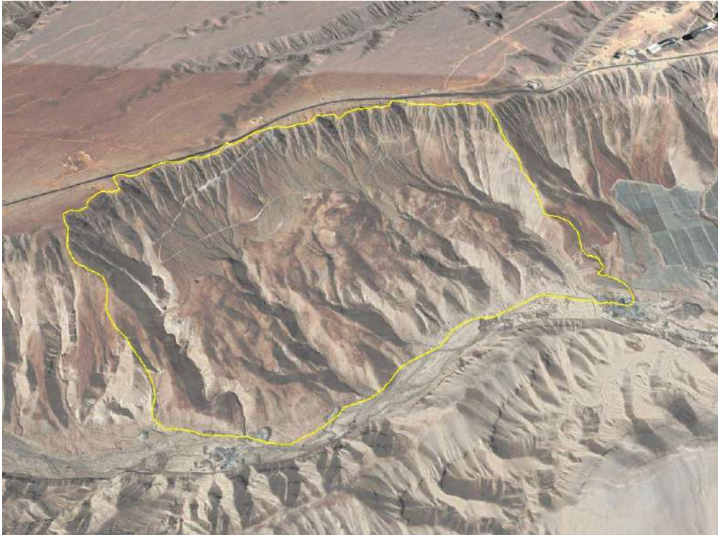
Figura 30: Vista con dirección al sureste de modelo 3D donde se ha delimitado con línea de color amarillo un deslizamiento en la margen izquierda de la quebrada Sausine; nótese la proximidad de viviendas y la carretera a la escarpa principal del deslizamiento. (Imagen Google Earth de setiembre de 2019).
