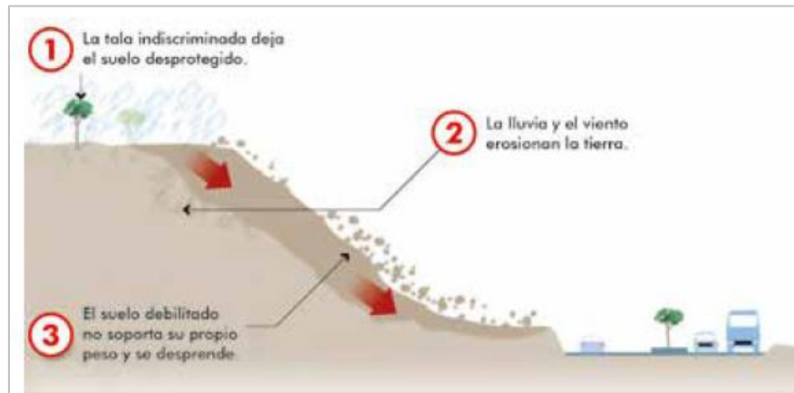
Figura N° 15: Etapas de erosión del suelo
