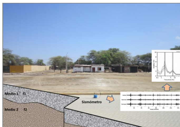
Figura 1: Esquema que muestra el registro de vibraciones ambientales.
