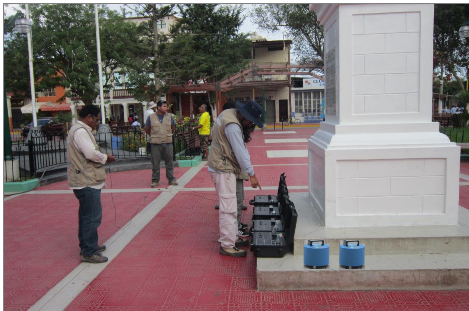
Figura 2: Equipo sísmico utilizado para el registro de vibraciones ambientales en Catacaos: sensor Lennartz (2N) y registradores CityShark II.
